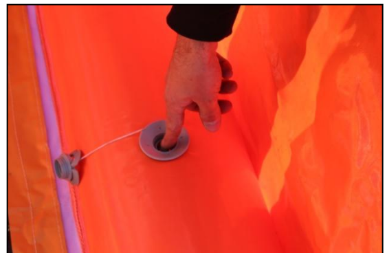
Stap 12: Duuw zo snelmogelijk de veer in het midden van de vuldop in en draai deze een halve slag terug zodat er geen lucht meer ontsnapt.
