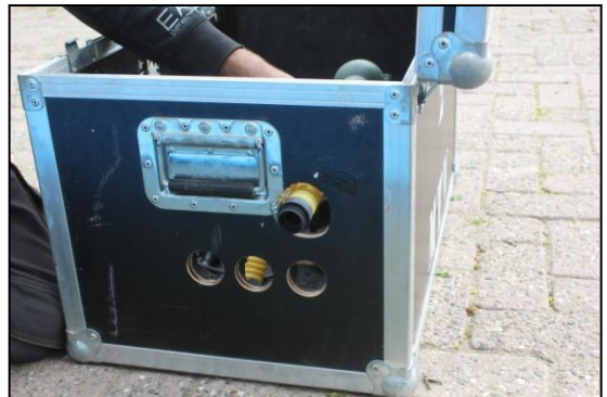
Stap 10: Haal de gele slang door het grootste gat aan de zijkant van de flightcase.
