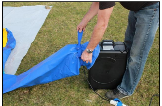
Stap 12: Sluit de blower aan. En sluit aan de andere zijde de luchtslang af.
