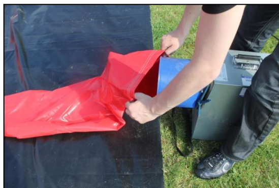
Stap 12: Sluit blower aan dmv van trekband die aan de aanvroegslang zit.
