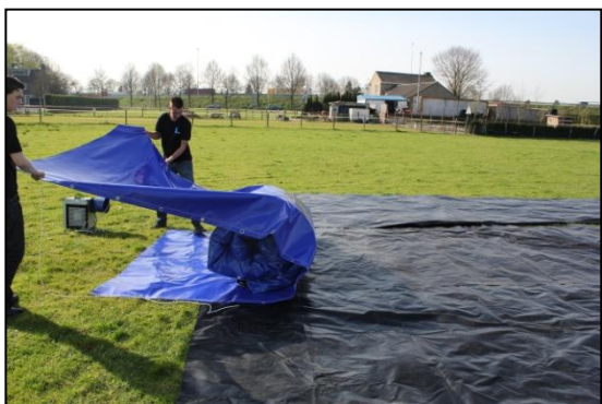
Stap 17: Rol/vouw transportzak om kussen en maak deze door rijgtouw vast.
