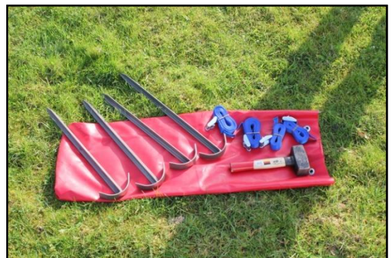
Stap 18: Het verankeringsset bestaat uit min. 4 haringen 4 spanbandjes en hamer.
