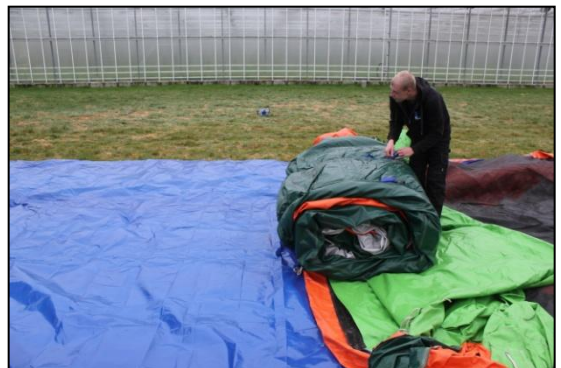
Stap 12: Plaats het luchtkussen deel 1 einde tegen skyswing-toren start.
