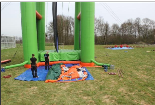
Stap 17: Vouw/trek het luchtkussen van links naar rechts 110-130cm.
