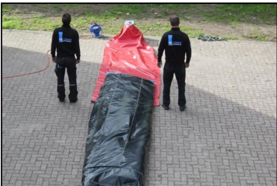
Stap 11: Plaats de transportzak op de spanband en leg het luchtkussen op de transportzak.
