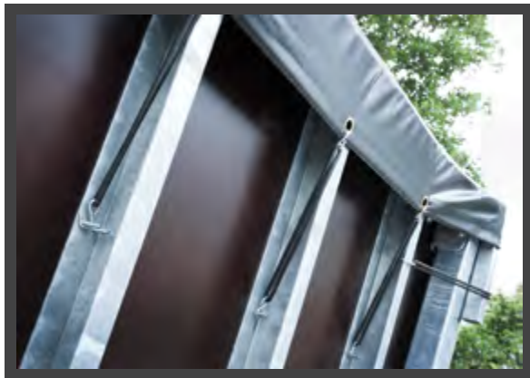
Maak het dekzeil los van het rechter- en linkervloerdeel en van de voor- en achterzijde. NB: Kijk goed of de dekzeilhoeken los zijn!
