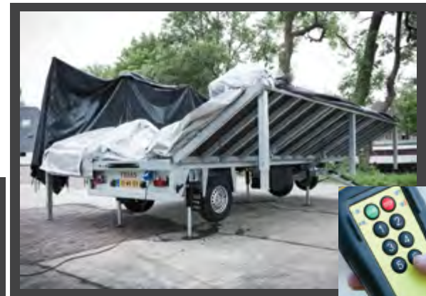
Laat het rechter vloerdeel zakken, houd het dekzeil goed in de gaten en kijk weer goed naar de ondergrond. Vul eventueel op met een stuk hout.
