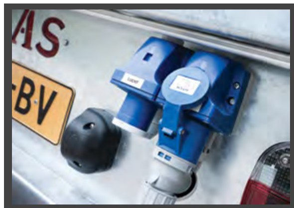
Sluit de kabel aan op een 220V geaard stopcontact of verlengsnoer. Sluit de meegeleverde kabel met CEE stekker aan op het Hydrauliek stopcontact.
