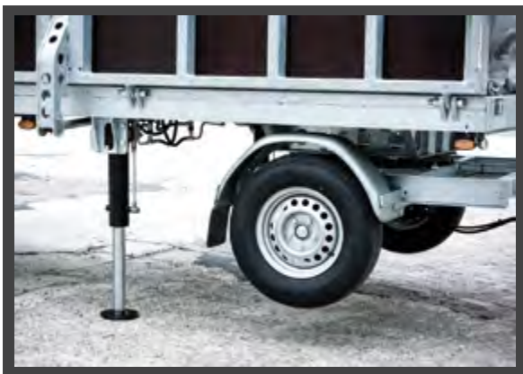
Stempel de trailer af. Zorg voor een goede ondergrond.
