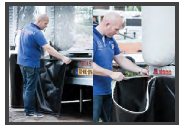
Haal de podiumrok los van het voorste en achterste deel door ze uit de rail te schuiven.
