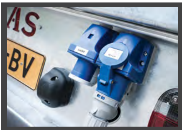
Sluit de kabel met CEE stekker aan op het Hydrauliek stopcontact.
