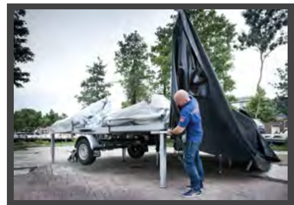
Haal het dekzeil van de podiumwagen af en berg deze op. Dit wordt gedaan d.m.v. de buizen onder het vloerdeel weg te schuiven.
