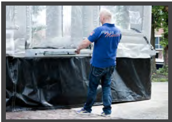
Haal de trap uit de beveiliging en trek deze onder de trailer vandaan.
