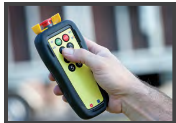
Druk op knop 1 van de afstandsbediening en de stempels komen onder de trailer weg.
