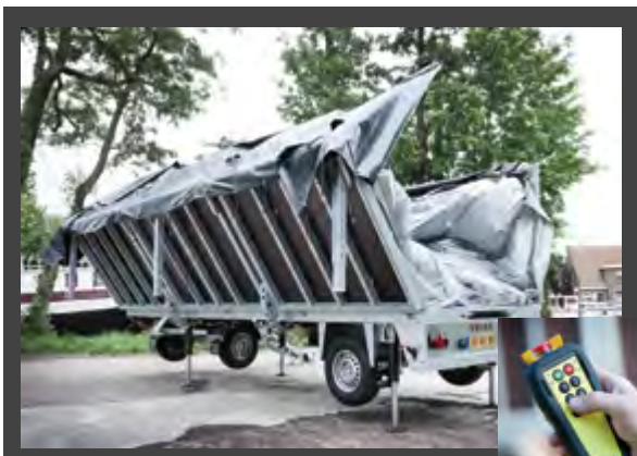
Laat dan het linkervloerdeel omhoog.
