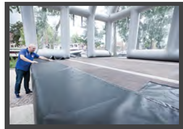
Haal de podiumrok los van het voorste en achterste deel door ze uit de rail te schuiven.
