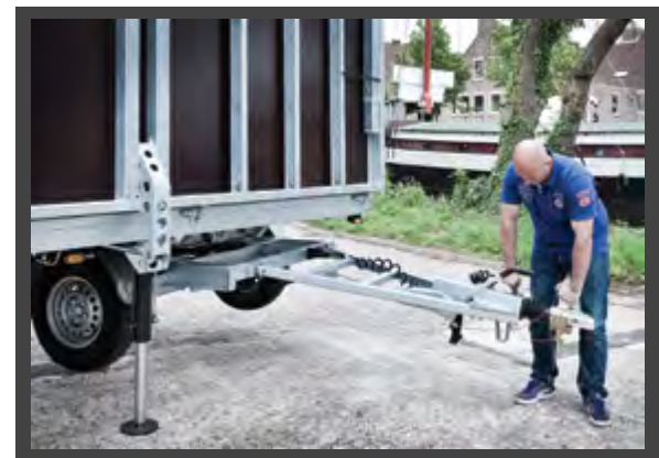
Draai de schamel zo ver mogelijk onder de trailer, zodat het spatbord haaks op de trailer staat.
