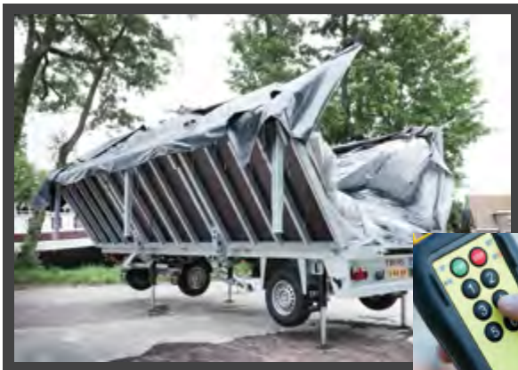
Laat eerst het linker vloerdeel zakken, kijk goed naar de ondergrond. Leg eventueel een stuk hout onder de poot om goed waterpas te stellen. Houd het dekzeil goed in de gaten!
